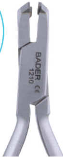
Corte distal corto, con retención de alambre. Hasta 0.52mm. 12,5cm. Ref. 1210
